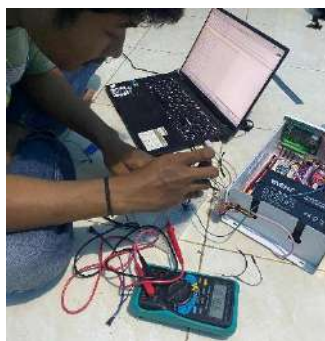
Gambar 40. Dokumentasi proses kalibrasi Modul ADC ADS1115
