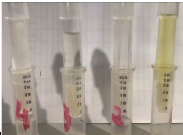
Gambar 5. Membran MWCO untuk memfraksinasi peptida
