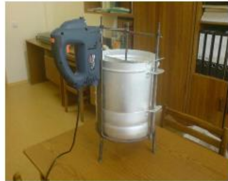
Gambar 3. Alat ekstraksi fisika ( extractor vibration ) Sumber : Orobinskaya et al. 2020
