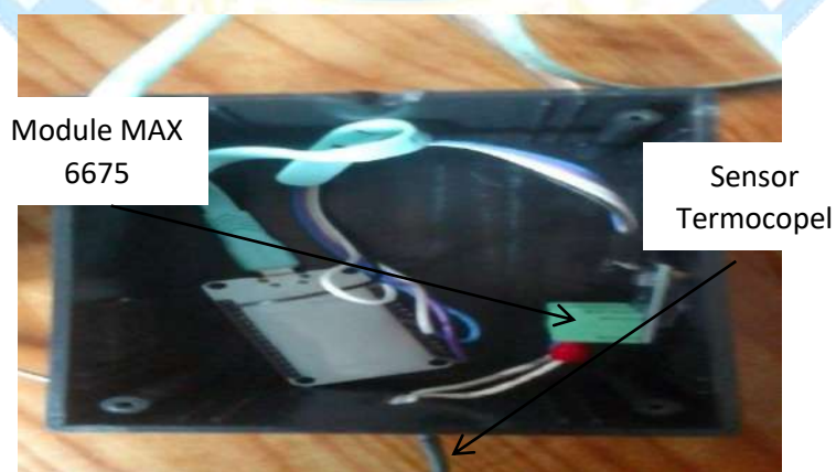
Gambar 36. Rangkaian Perangkat Master 1
