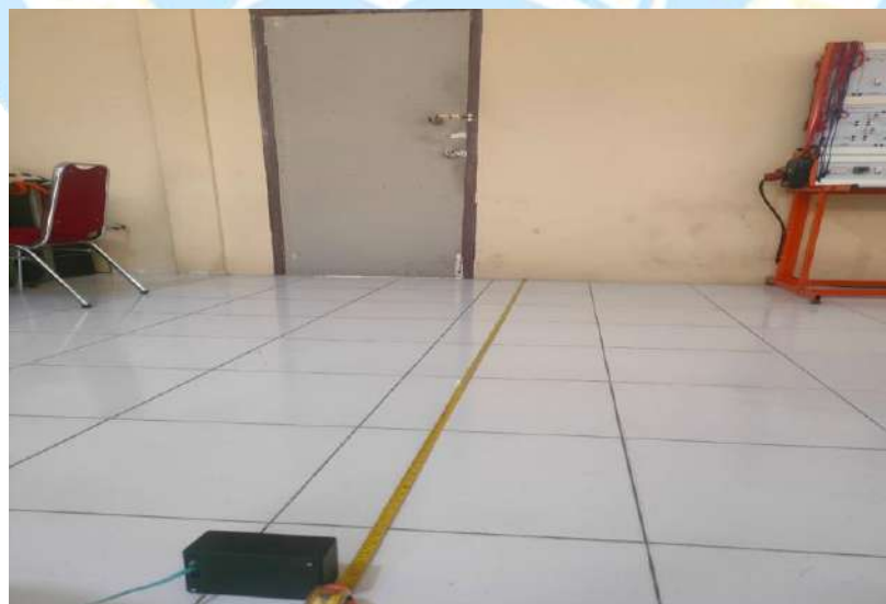
Gambar 32. Pengujian sensor ultrasonik A02YYUW terhadap objek
