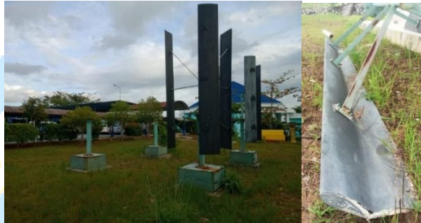
Gambar 1. Kerusakan material sudu kincir angin jenis Darrieus H
