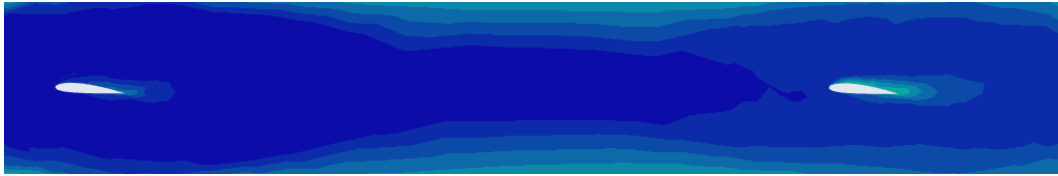
Gambar 38. Pola Aliran Dan Turbulensi Variasi Front Hydrofoil (Sumber : Data diolah,2025)
