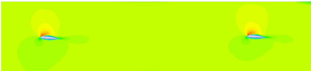
Gambar 36. Distribusi Kecepatan pada variasi Back Sweep Hydrofoil (Sumber : Data diolah, 2025)
