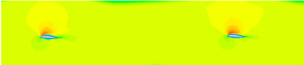
Gambar 34. Distribusi Kecepatan pada variasi Flat Hydrofoil (Sumber : Data diolah, 2025)
